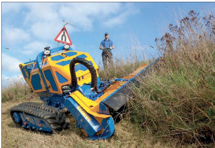
Novinkou, která si už v České republice našla uživatele, je pásová rádiově ovládaná sekačka Bomford Flailbot
