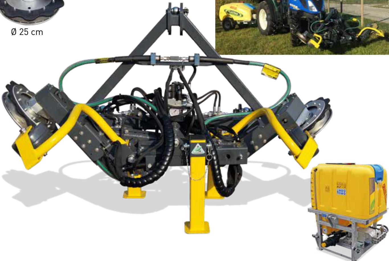
Il modello Twin permette la lavorazione dei 2 lati del filare con un unico passaggio. Posizionato nella parte anteriore del trattore dispone di tutte le regolazioni idrauliche azionabili dalla cabina. Nel caso il trattore sia sprovvisto del sollevamento frontale è disponibile come optional un elevatore frontale da applicare al trattore stesso. La fascia di lavoro per ogni singola testata è di 25 cm. Il consumo totale di acqua delle due testate è sempre di un litro ogni 3 metri lineari.
